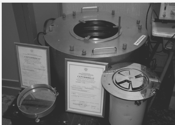
Рис 1. Изображены КНЭП-1 (вверху), первичный преобразователь СИ Е (внизу справа) и устройство для контроля СИ (внизу слева).
