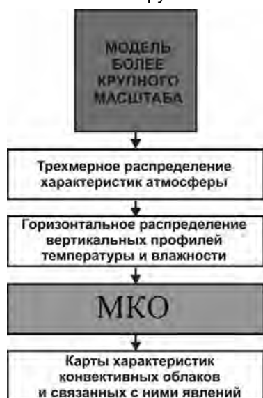
Рис. 1. Схема взаимодействия МКО с моделями более крупного масштаба
