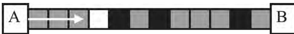
Рис. 1. Одномерная цепочка клеточных автоматов. Черный цвет соответствует блокирующим ячейкам - изоляторам, серый – проводящим ячейкам, белый - проводящим ячейкам, содержащим единицу заряда
