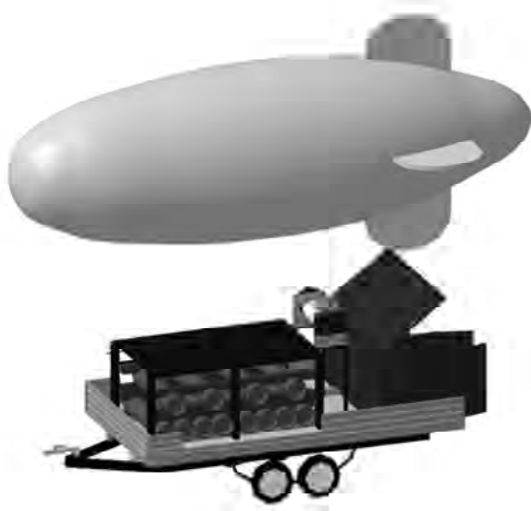
Рис. 1 Общий вид прицепа с установленными на нем гелиевыми баллонами, лебедкой, ящиком для оборудования и материалов.
