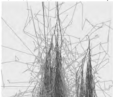
Рис 1. Каскады частиц произведенные единственным электроном с E = 1 МэВ в электрическом поле 5 кВ/см. Электроны, позитроны, и фотоны представлены красным, синим, и зеленым цветом линий. Начальная точка в центре.
